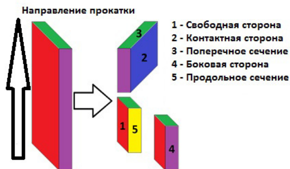
Рис. 1 - Схема подготовки образцов для электронно-микроскопического исследования
